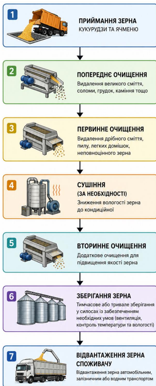
Рисунок 2.1 – Загальна технологічна схема з післязбиральної обробки зерна зернових культур
