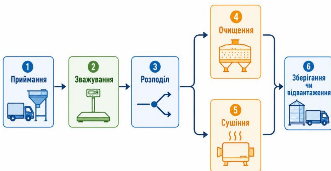
Рисунок 3.4 – Послідовність технологічних операцій на удосконаленій лінії
