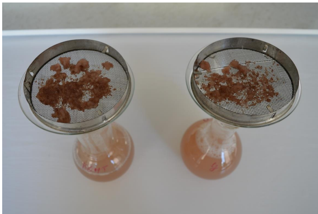
Рис. 7. Осад на ситі після фільтрування перевару з використанням еталонного (А) і дослідного пепсину (Б)
