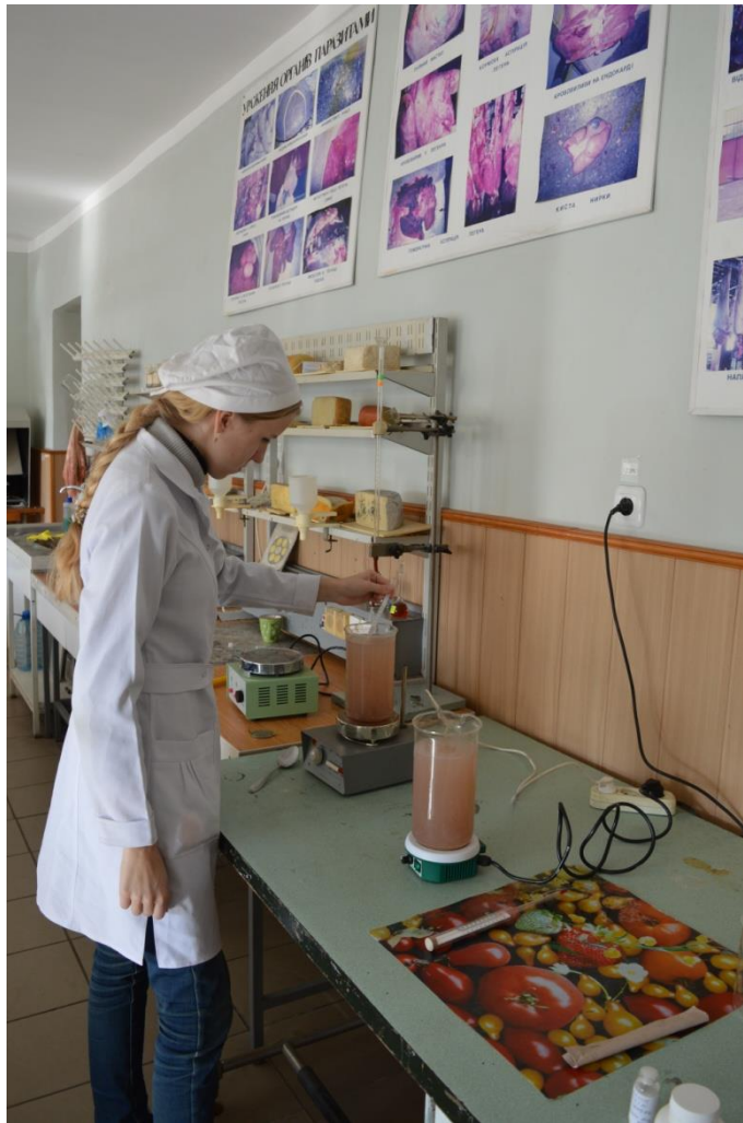
Рис. 2. Перетравлення м'язової тканини у штучному шлунковому соці на магнітній мішалці
