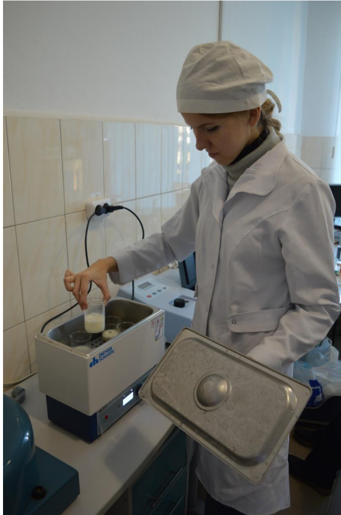
Рис. 4. Підігрівання молока на водяній бані до (35,0 \pm 0,5) ^\circ\text{C}
