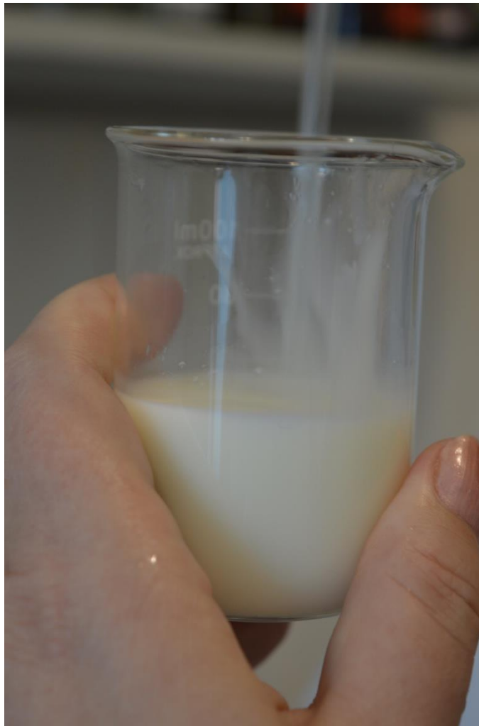
Рис. 8. Нанесення молока на стінки стакана за допомогою скляної палички для визначення початку утворення пластівців параказеїну.
