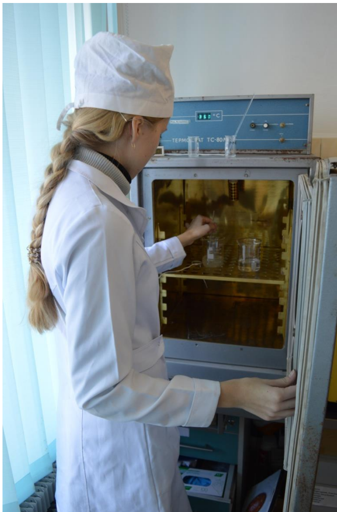
Рис. 3. Витримування розчинів пепсину у термостаті за температури (35,0 \pm 0,5) \text{ } ^\circ\text{C}
