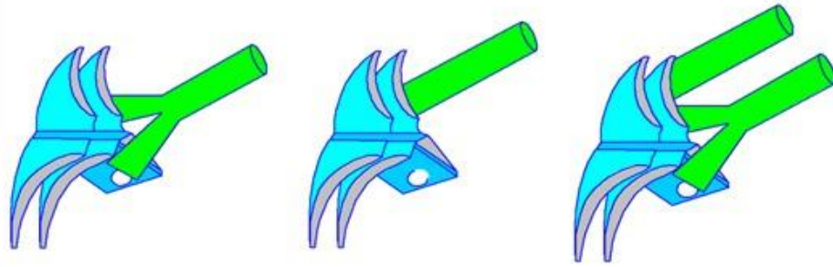
Рисунок 3 - Види взаємодії комбінованого ножа зі стеблом
