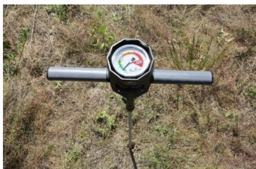
Рис. 2. Пенетрометр механічного типу. Без прив'язки до GPS.
