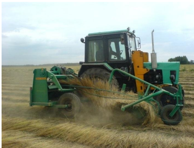
Рис. 2.5. - Обертач стебел льону в роботі
