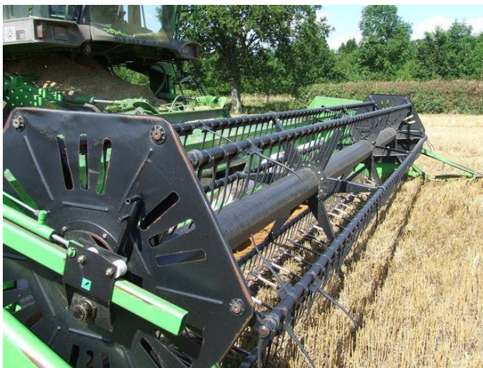
Рис. 3.2 – Мотовило зернової жнивarki як основний робочий орган підведення стеблостою
