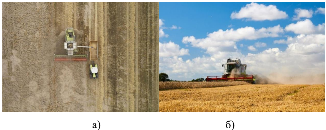
Рис. 2.1 – Основні способи збирання ячменю, а – пряме комбайнування; б – роздільне збирання з попереднім формуванням валків
