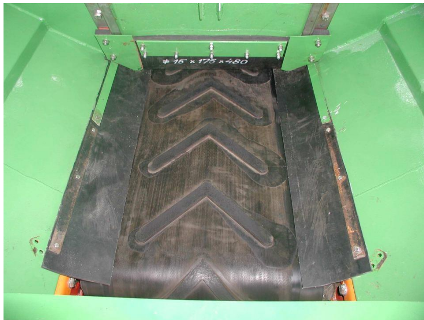
Рис. 2.3. Удосконалений дозуючий пристрій (стрічковий привід).
