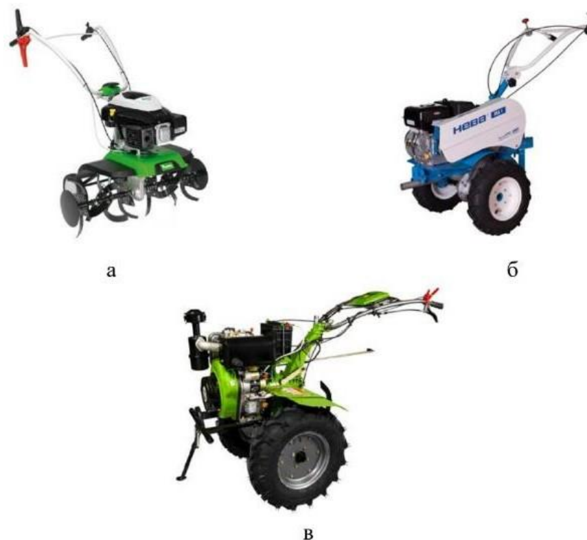
Рисунок 1.2 – Конструкції мотоблоків в залежності від маси. а - легкі; б - середні; в - важкі.
