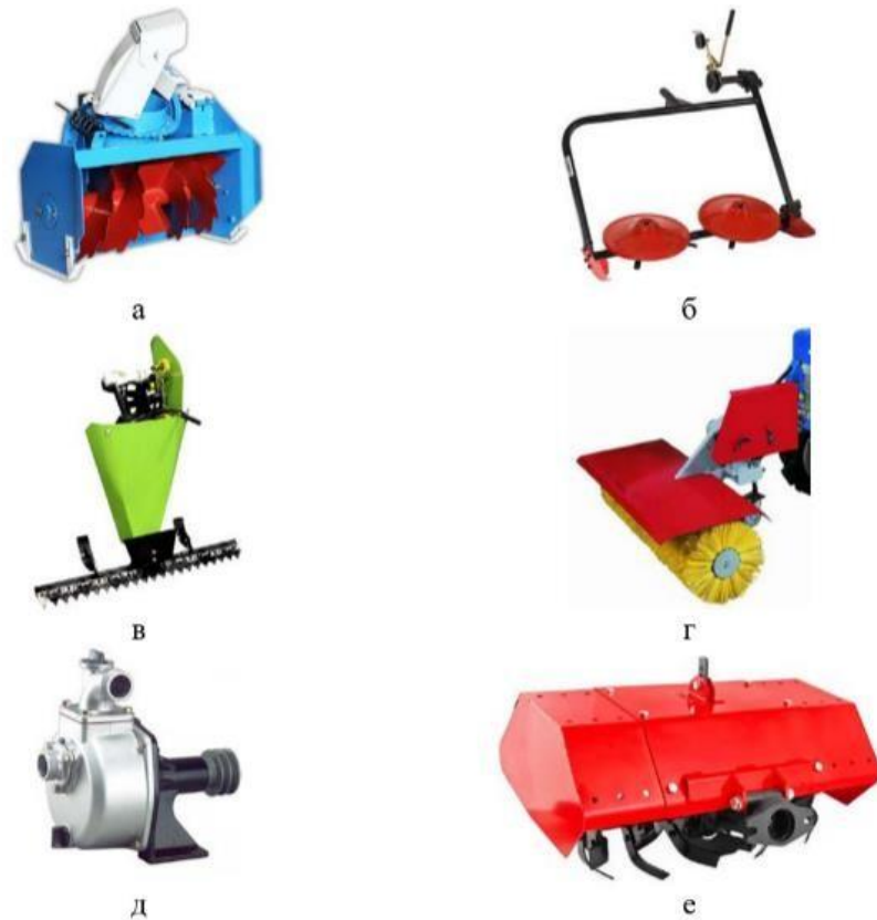
Рисунок 1.3 – Змінні адаптери з приводом від валу відбору потужності: а - роторний (сніговідкидачі); б - роторна косарка; в - сегментно-пальцева косарка; г - щітка; д - помпа; е - насадка-культиваторна фреза.
