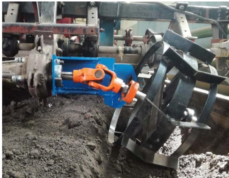
Рисунок 3.5 – Експериментальний модуль для визначення сили тяги на ведучих колесах
