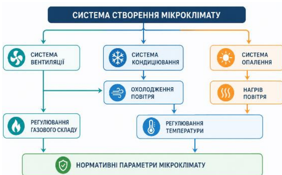
Рисунок 1.5 – Принципова схема функціонування системи забезпечення мікроклімату
