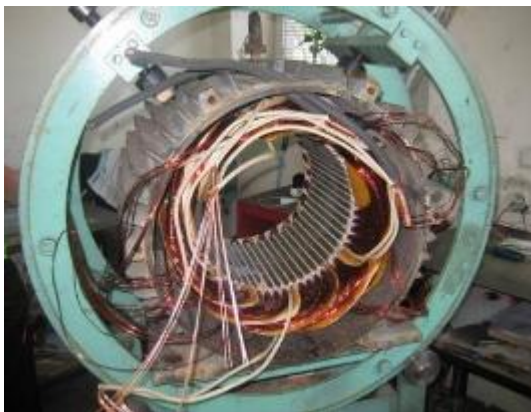
Рисунок 1.1 – Елементи технологічного процесу ремонту електричних машин
