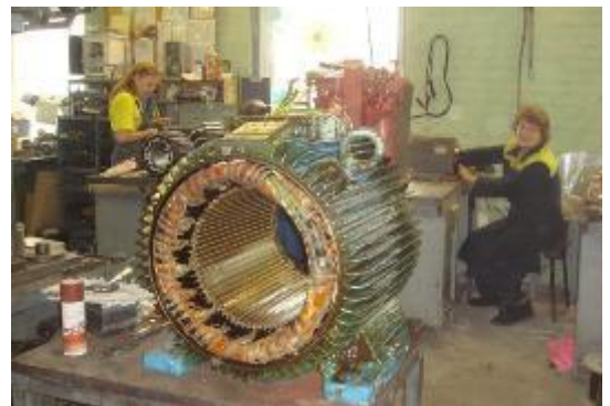
Рисунок 1.1 – Елементи технологічного процесу ремонту електричних машин
