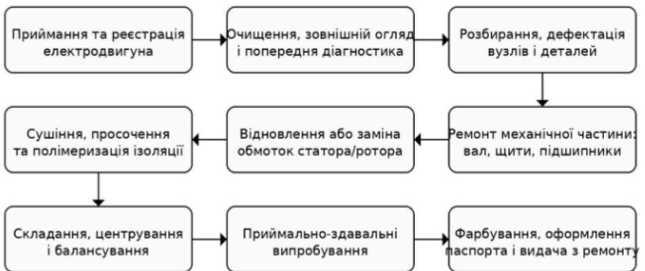
Рисунок 2.1 - Схема технологічного процесу ремонту електродвигуна
