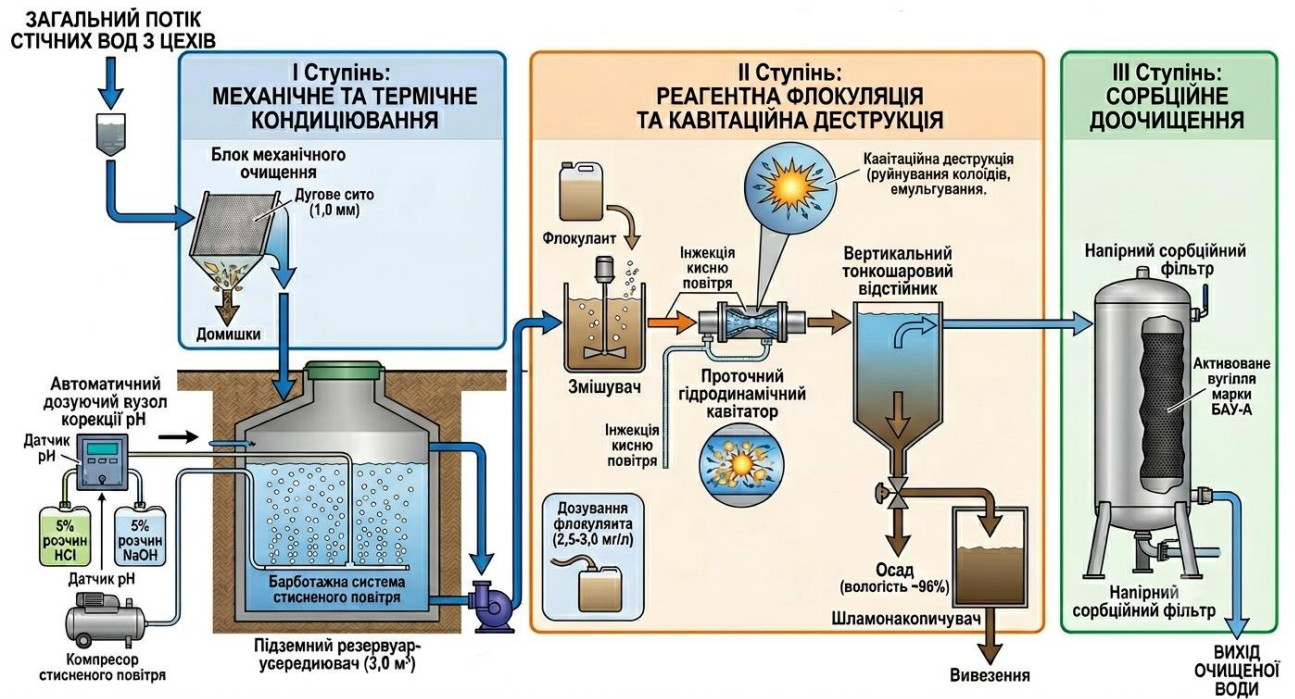
Рисунок 3.2. Триступенева система очищення стічних вод пивоварні
