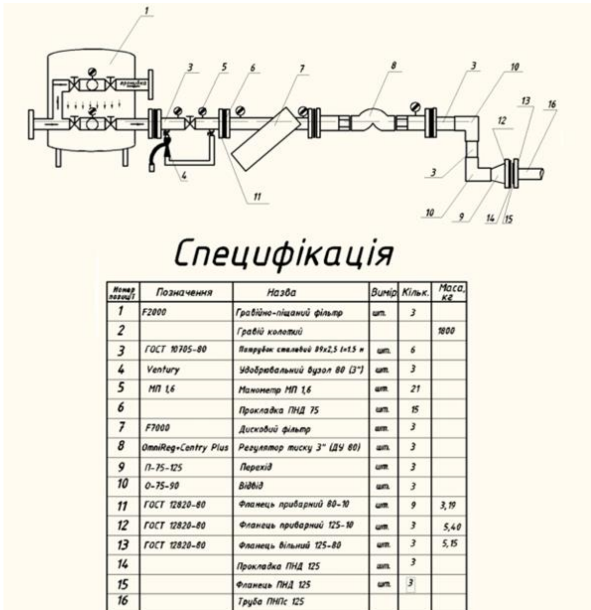
Рисунок 4.4 - Монтажна схема фільтростанції
