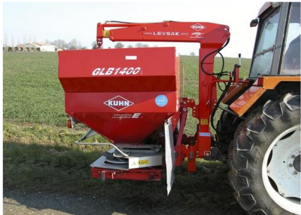
Рисунок 3.10 - Розкидач мінеральних добрив з навантажувачем мішків LEVSAK
