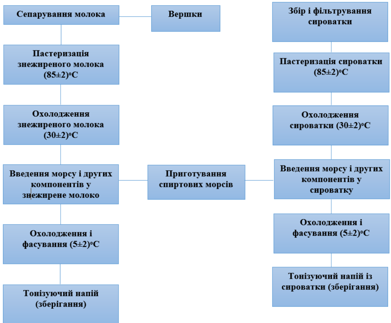
Рисунок 4.1 – Загальна технологічна схема виробництва тонізуючих напоїв на молочній основі
