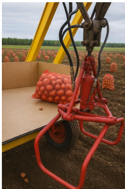
Рисунок 3.7 – Дослідження ефективності роботи захвату навантажувача
