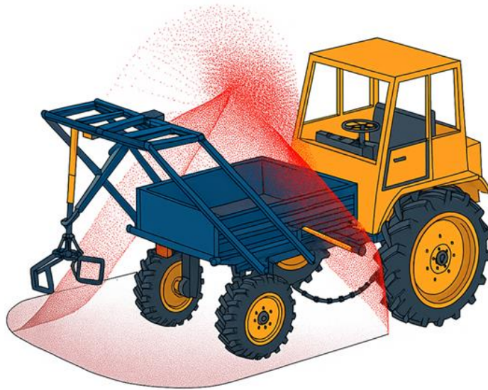
Рисунок 2.4 – 3D візуалізація множини точок робочої зони навантажувача
