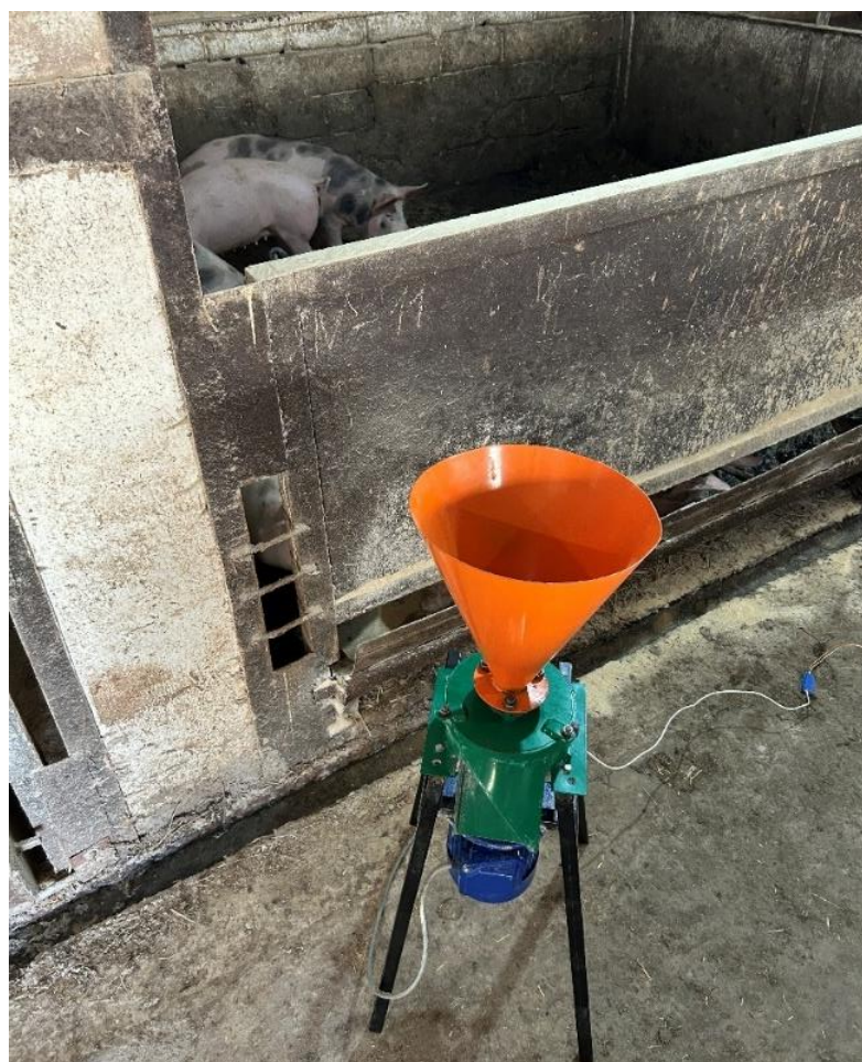
Рисунок 5.1 – Виробничі випробування дискового подрібнювача
