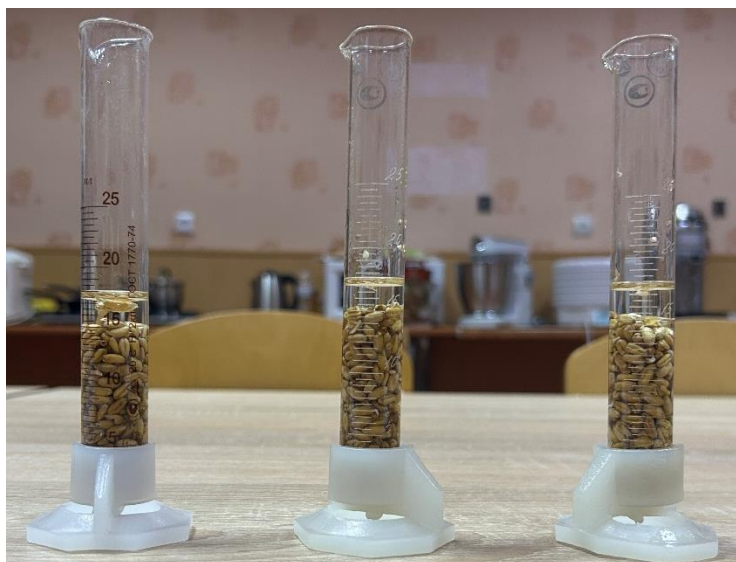
Рисунок 3.21 – Визначення об'єму наважки зерна пшениці
