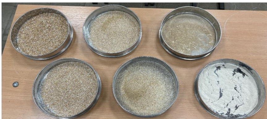
Рисунок 3.20 – Розподіл подрібненої маси по ситах з різними діаметрами отворів
