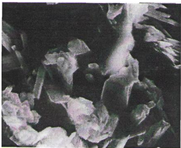
Рис. 3. Электронная микрофотография поверхности скола гипсового образца ( \times 3\ 500 )
