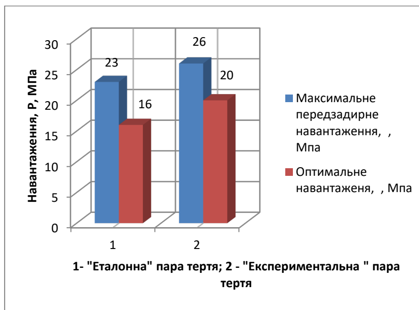
Рисунок 25 - Середнє значення максимальних передзадирних і оптимальних навантажень для «еталонних» та «експериментальних» пар тертя
