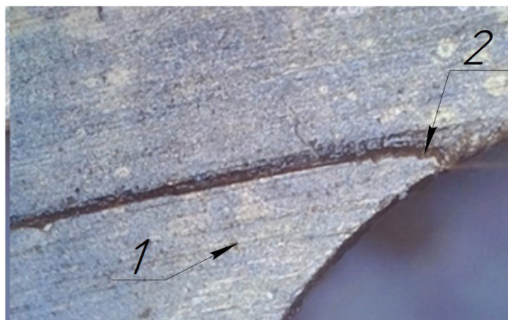
Рисунок 11 – Зовнішній вид зношення приставного дна (збільшення 1200х):
