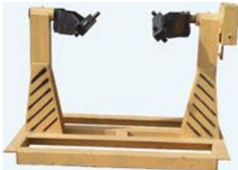
Рисунок 3.2 - Стенд марки СТУ-300 (М-401) для розбирально-складальних робіт з двигунами КамАЗ та ЯМЗ.
