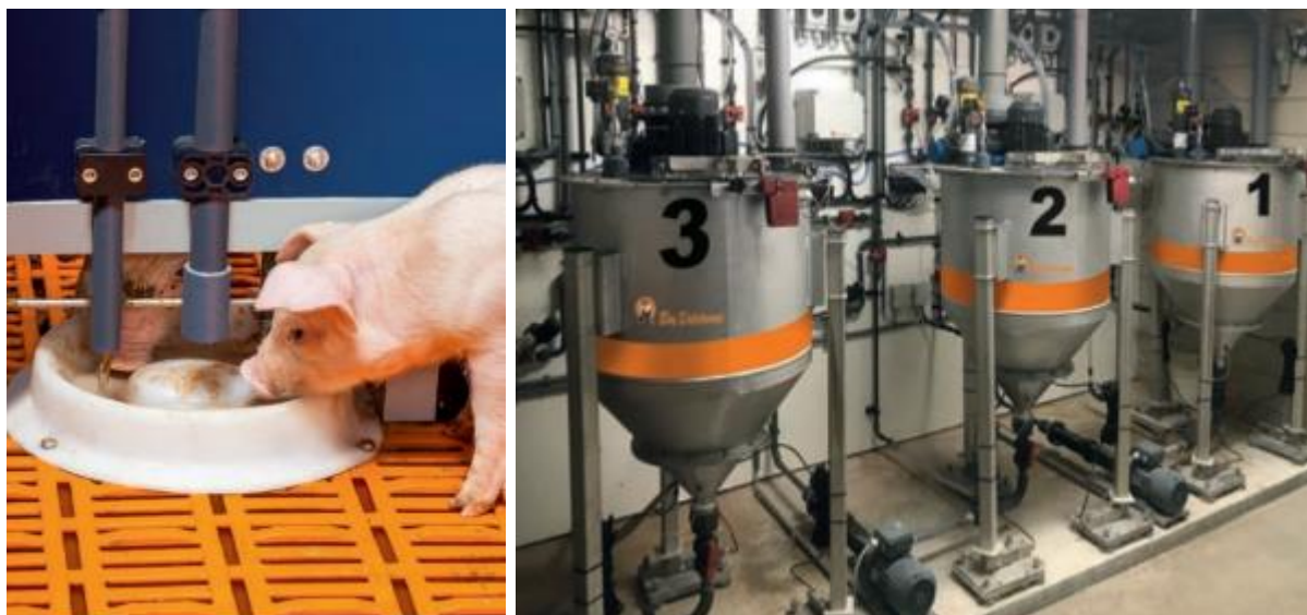
Рисунок 1.3 – Технологічна система рідкої годівлі поросят Culina Cup виробництва Big Dutchman
