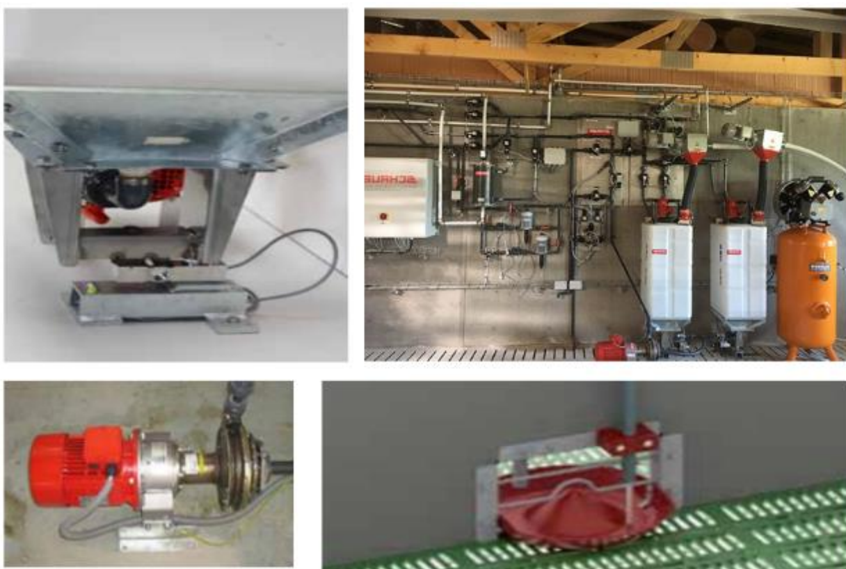
Рисунок 1.5 – Автоматизована система рідкої годівлі поросят Babyfeed (Schauer)
