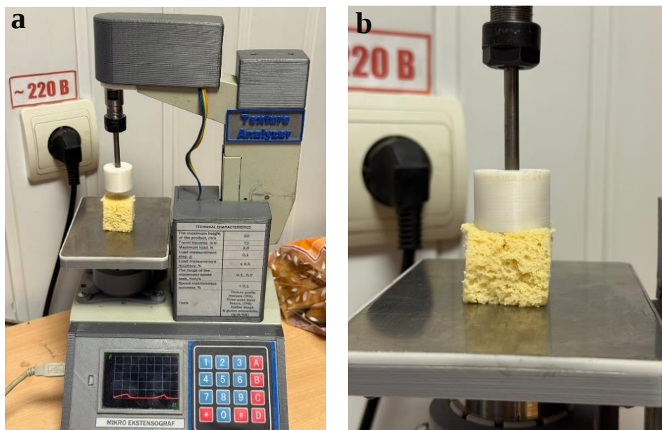
Рисунок 2.5 – Аналізатор текстури: а – прилад; б – стиснення зразка хлiба
