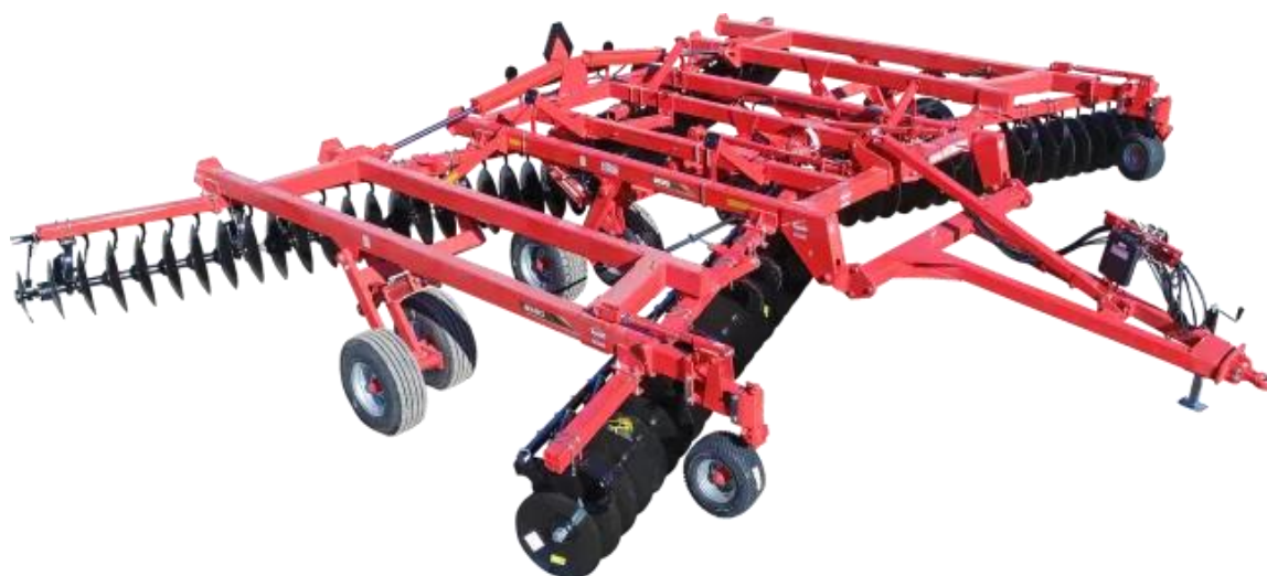
Рисунок 1.9 – Багатоцільові тандемні борони KUHN Krause Class II 8220
