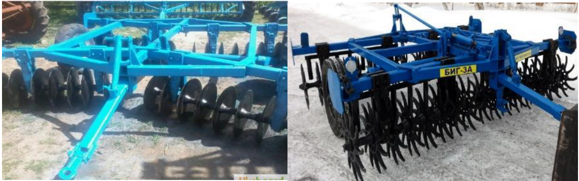
Рисунок 1.2 – борона БІГ-3 (а) та голчаста борона БІГ-3А (б)
