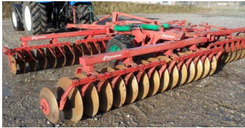
Рисунок 1.5 – Дискові знаряддя Kverneland DTB (Норвегія)
