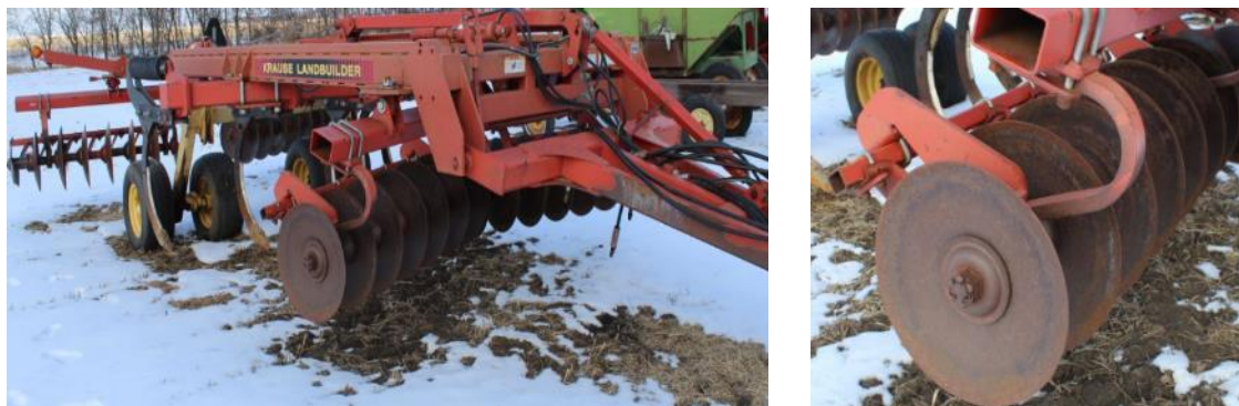
Рисунок 1.10 – Дисковий розпушувач Krause 4880 Land Builder
