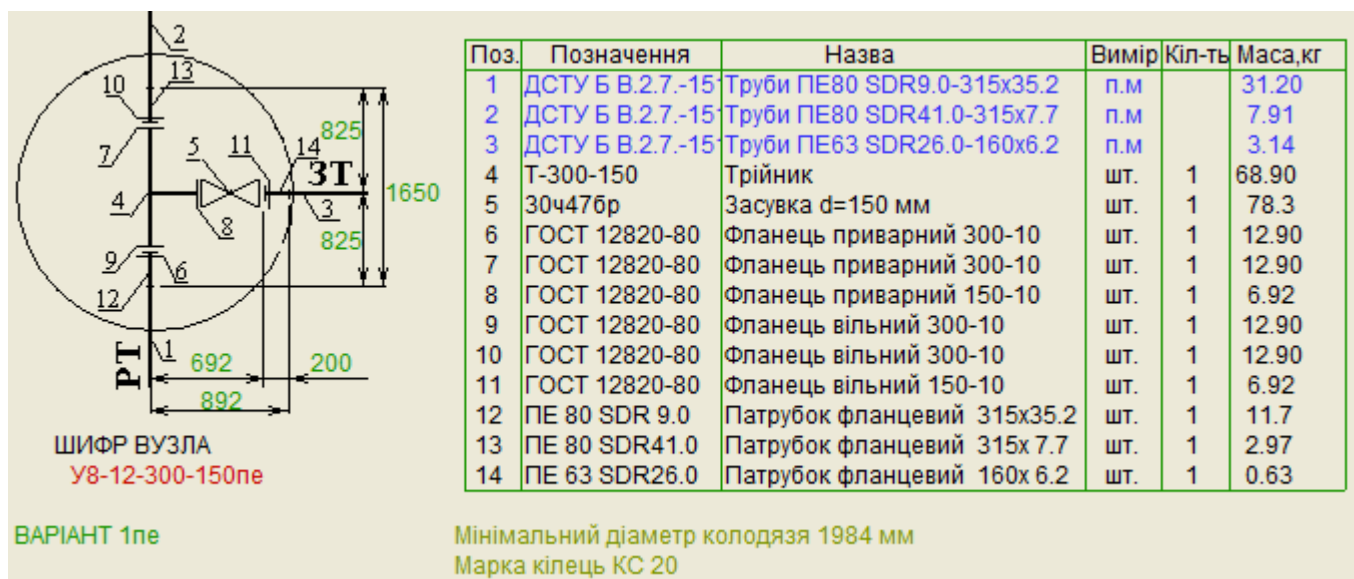
Рисунок 4.6 – Комплектування розподільчого колодязя Р-1 на трубопроводі 1-Кр
