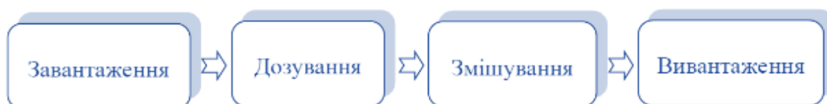
Рисунок 3.3 – Технологічна схема лінії дозування та змішування кормових компонентів
