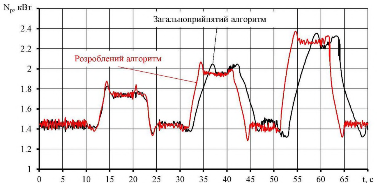
Рисунок 4.19 – Динаміка зміни потужності привода вакуумного насоса N_p для запропонованих алгоритмів
