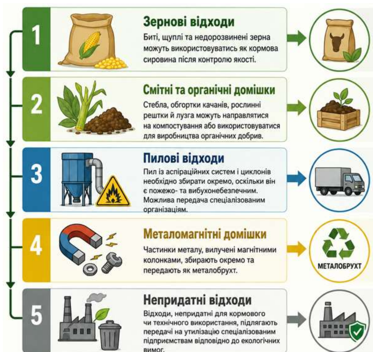
Рисунок 5.1 – Основні шляхи утилізації відходів на підприємствах з первинної обробки зерна
