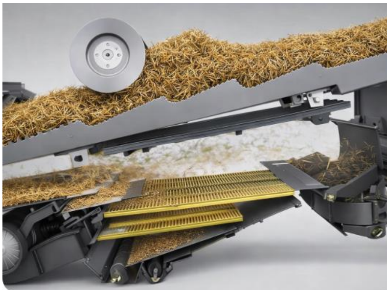
Рис. 2.5. Схема клавішно-каскадного соломотряса та системи очистки компанії CLAAS [4]
