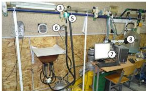
Рисунок 5 - Експериментальний стенд: 1 – макет вимені; 2 – стакан ДА; 3 – вакуум-молочний кран; 4 – колектор ДА; 5 – пульсатор ДА; 6 – АЦП NI-6008; 7 – ПЕОМ; 8 – молокозбірник; 9 – вакуумметр; 10 – вакуумрегулятор; 11 – вакуумбалон; 12 – зворотній клапан; 13 – вакуумнасос
