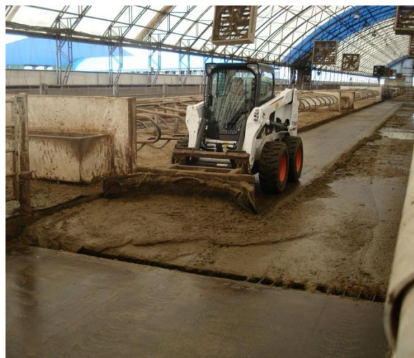
Рисунок 1.4 - Видалення гною з корівників
