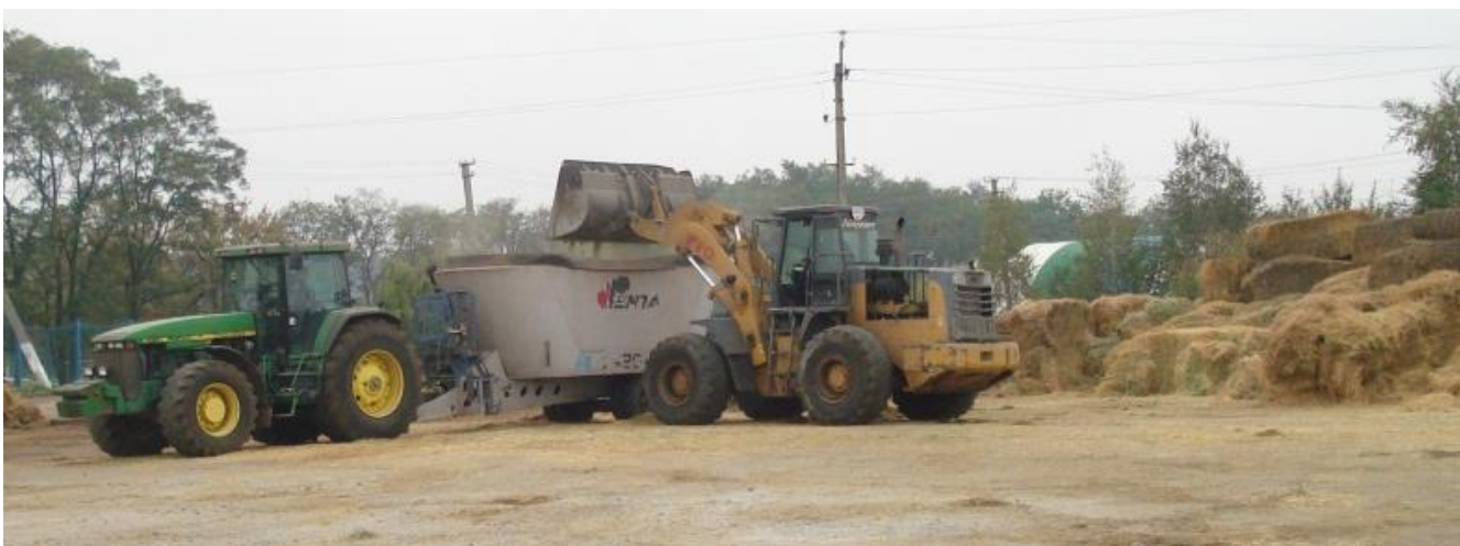
Рисунок 1.2 - Процес завантаження кормового комбайна Penta
