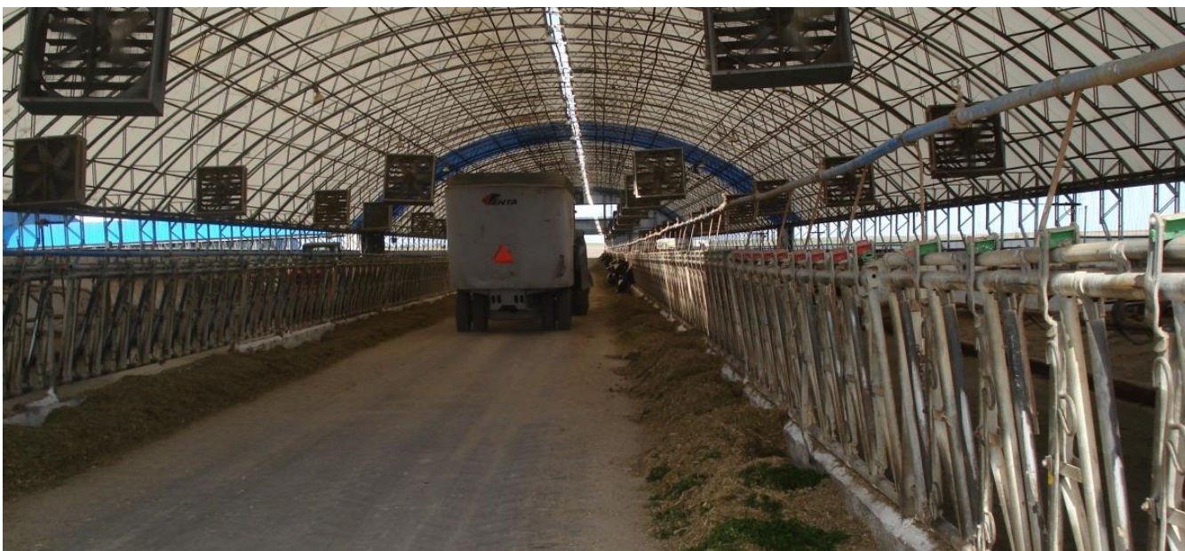
Рисунок 1.3 - Роздавання кормів кормовим комбайном Penta
