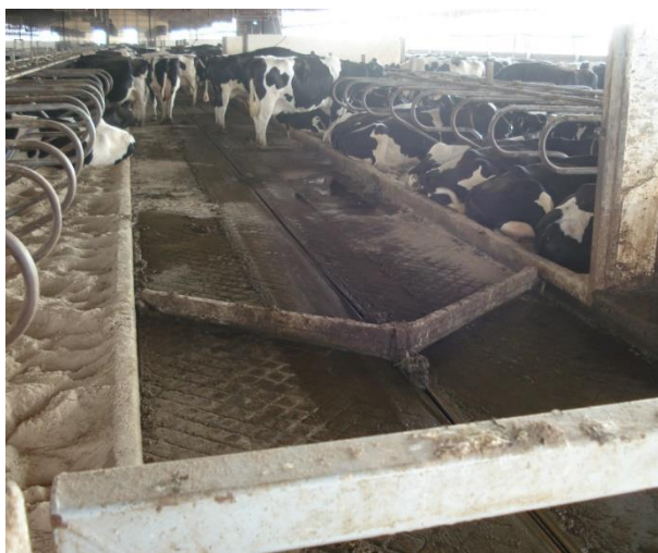
Рисунок 1.4 - Видалення гною з корівників
