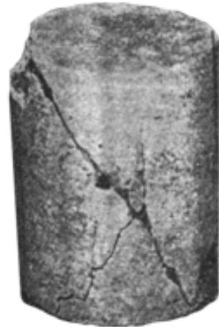
Рисунок 1 – Зразок клинової форми руйнування за Л.І. Бароном
