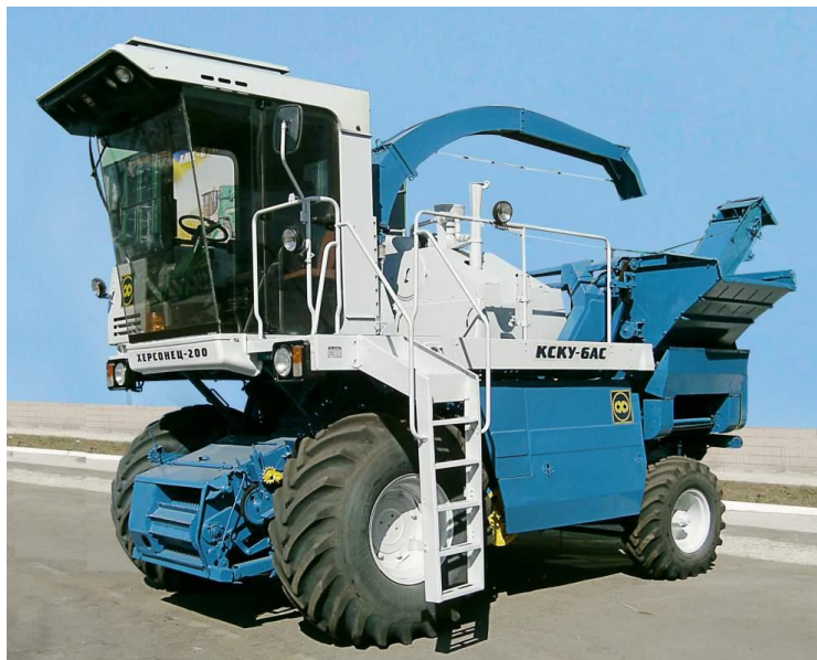
Рис. 3.1. - Комбайн кукурудзозбиральний самохідний КСКУ-6 АС
