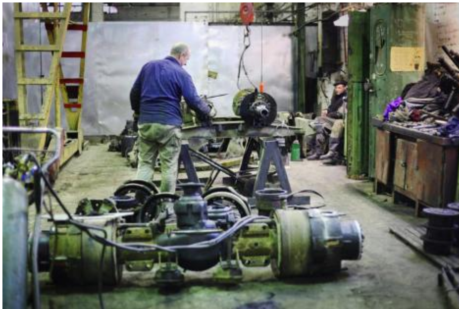
Рисунок 1.4 – Ремонт мостів вантажних автомобілів у зоні ТО та ПР
