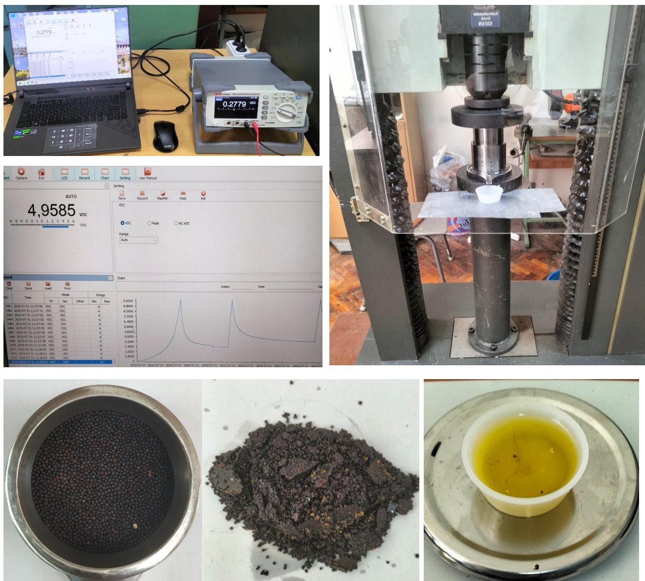
Рисунок 2.3 – Загальний вигляд обладнання для пресування насіння ріпаку і результат пресування (макуха і олія)
