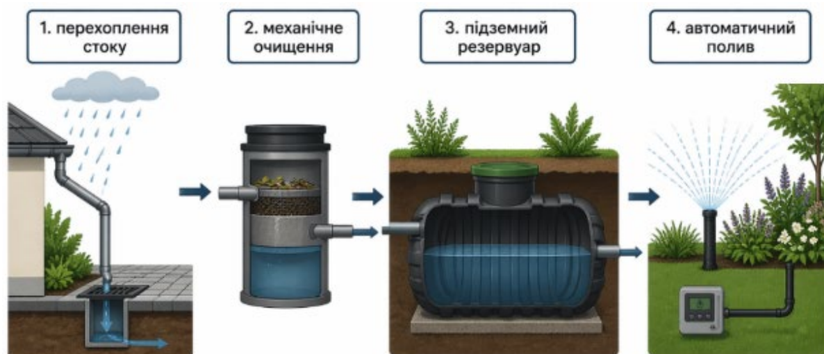
Рисунок 3.11 - Принципова технологічна схема управління поверхневим стоком на муніципальних об'єктах (NbS)
