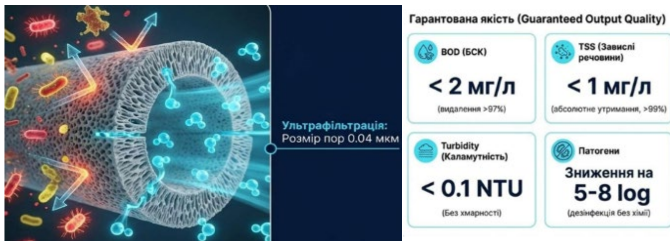
Рисунок 3.10 - технологія MBR: абсолютний фізичний бар'єр
