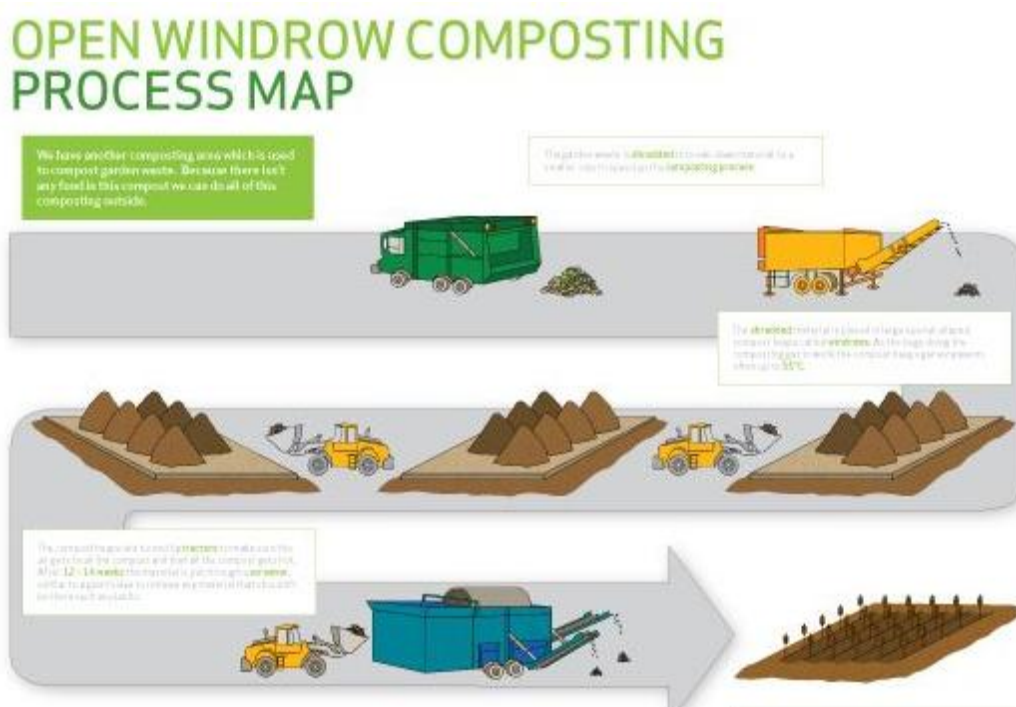
Рисунок 3.2 - Структурно-логічна схема процесу відкритого компостування муніципальних відходів: від підготовки до отримання готового продукту [64]
