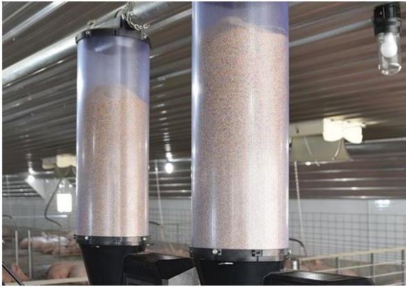
Рис. 1.. Елементи автоматизованої системи подачі корму
