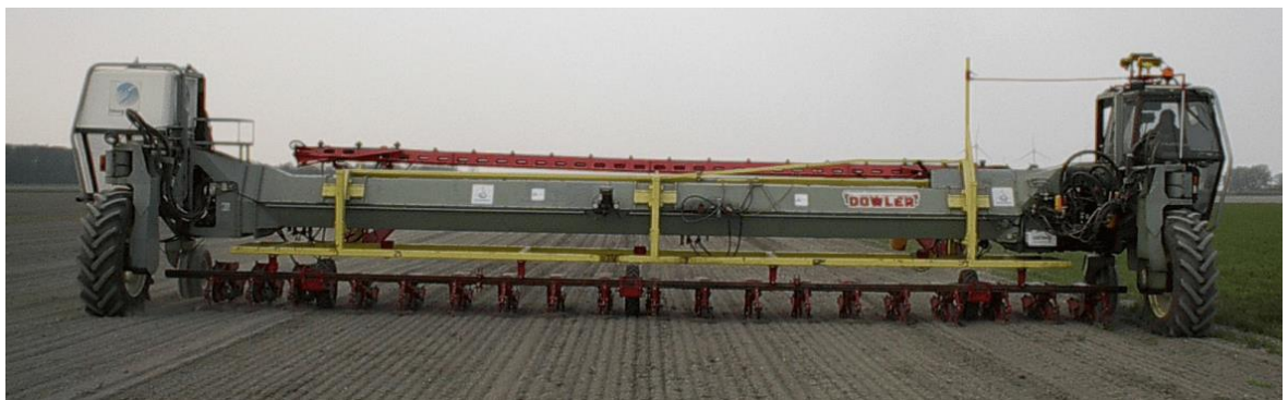
Рис. 2.4. Портальний трактор Девіда Довлера а – модель 1975 року; б – сучасна модель
