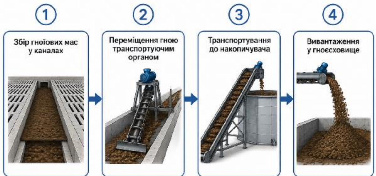
Рисунок 1.1 - Технологічний процес видалення гною
