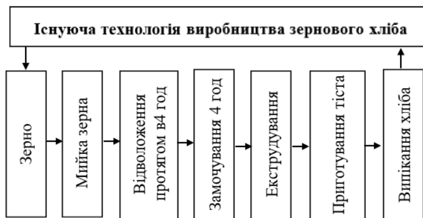
Рисунок 1.1 – Функціональна схема існуючої технології виробництва зернового хліба
