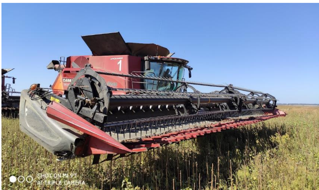
Рис. 3.2. Зернозбиральний комбайн Case IH 9240 у агрегаті із зерною жаткою MacDon FD 75, модернізованою для збирання соняшника: доукмоплектовано ліхтери. Ширина захвату 13,75 м.
