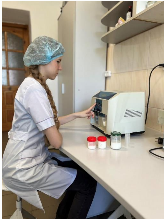
Рис. 6. Дослідження молока на ультразвуковому аналізаторі молока «Ekomilk тип MILKANA КАМ 98-2а»
