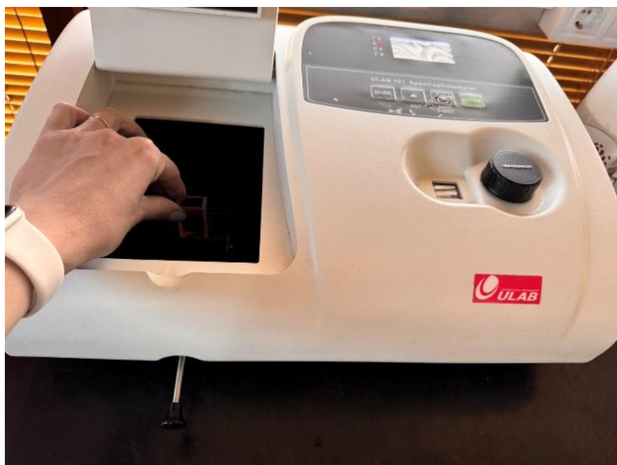
Рис. 3. Визначення сечовини в молоці за допомогою спектрофотометру ULAB 101
