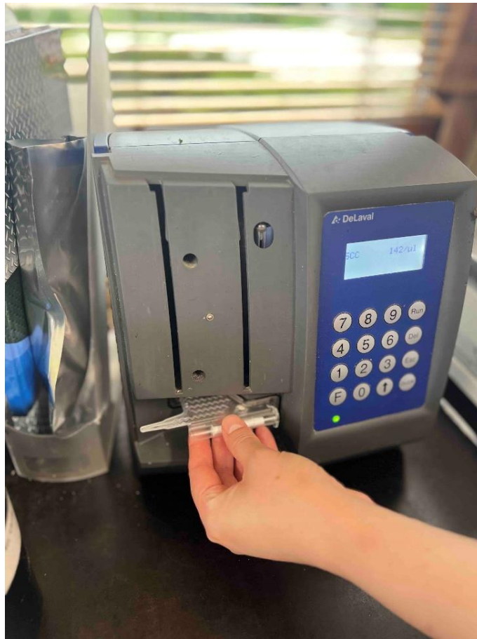
Рис. 2. Визначення кількості соматичних клітин в молоці за допомогою аналізатора «DCC»
