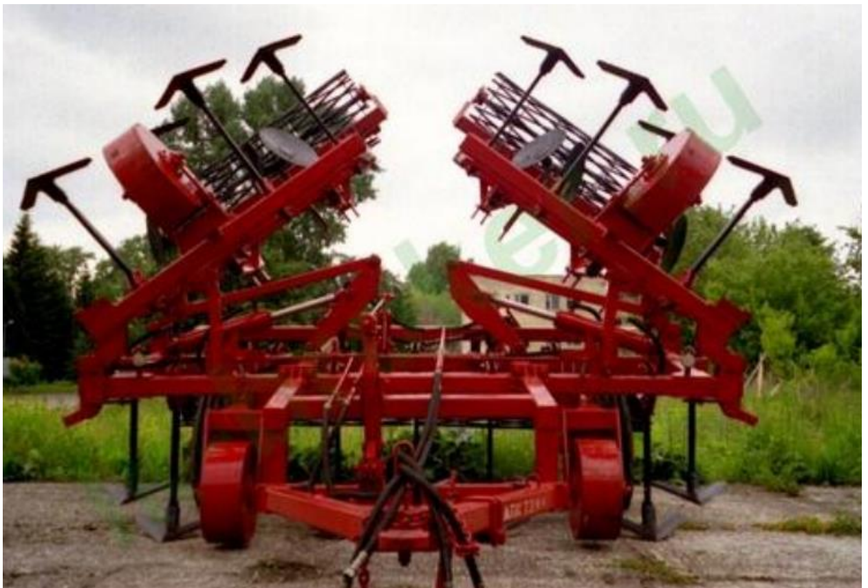
Рис. 1.4 – Агрегат ґрунтообробний комбінований АПК - 7,2
