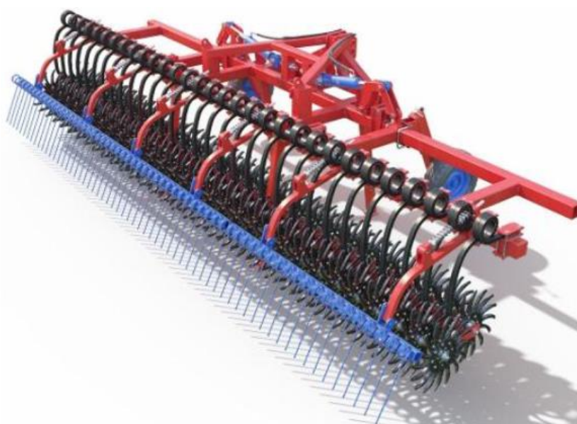
Рис. 1.9 – Роторна борона Striegel компанії «Hatzenbichler»
