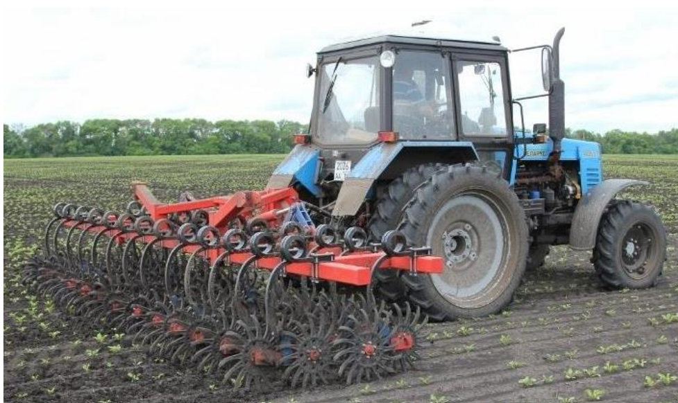
Рис. 1.10 – Важка ротаційна борона - мотика «ІГЛОВАТОР II»
