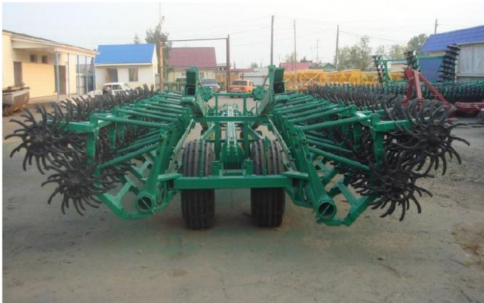
Рис. 1.5 – Борона - мотика широкозахватна БМШ – 15
