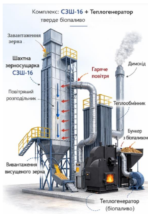
Рисунок 1.13 – Проект модернізації СЗШ-16 з теплогенератором
