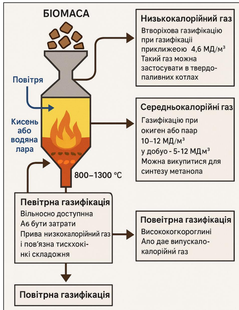
Рисунок 2.2 – Схема газифікації біомаси
