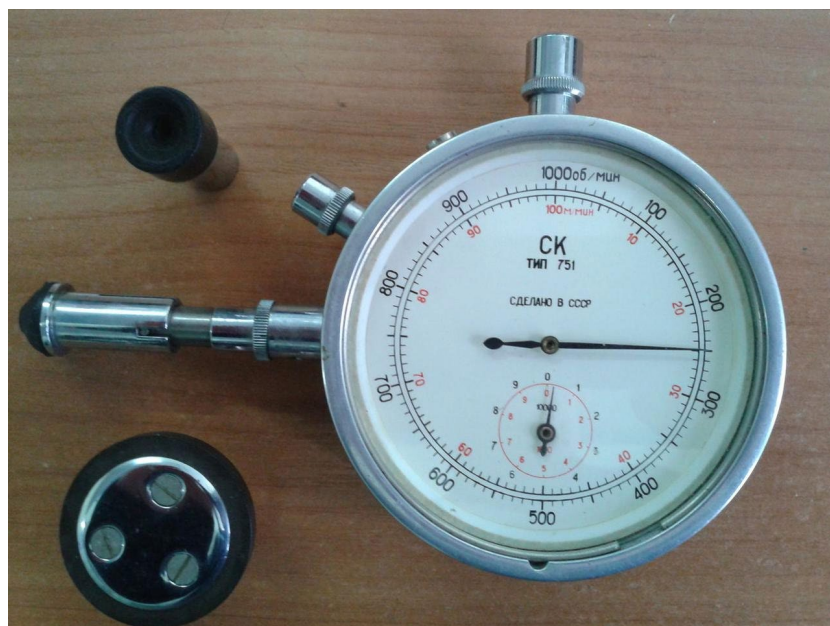
Рисунок 3.6 – Фрикційний тахометр СК тип 751
