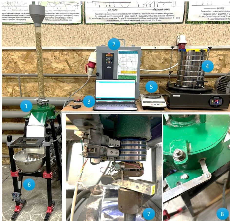
1 – дисковий подрібнювач; 2 – стенд для керування електроприводами на основі частотного перетворювача Danfoss; 3 – ПЕОМ; 4 – розсіювач лабораторний РЛУ-3К; 5 – ваги лабораторні JD-2200-2; 6 – система зважування у поточному часі готового продукту; 7 – вимірювач крутного моменту; 8 – отвір для встановлення модульного зазору
