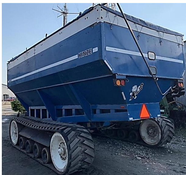
Рисунок 2.6 – Бункер-перевантажувач Kinze 840 ТТ ( V = 30 \text{ м}^3 )
