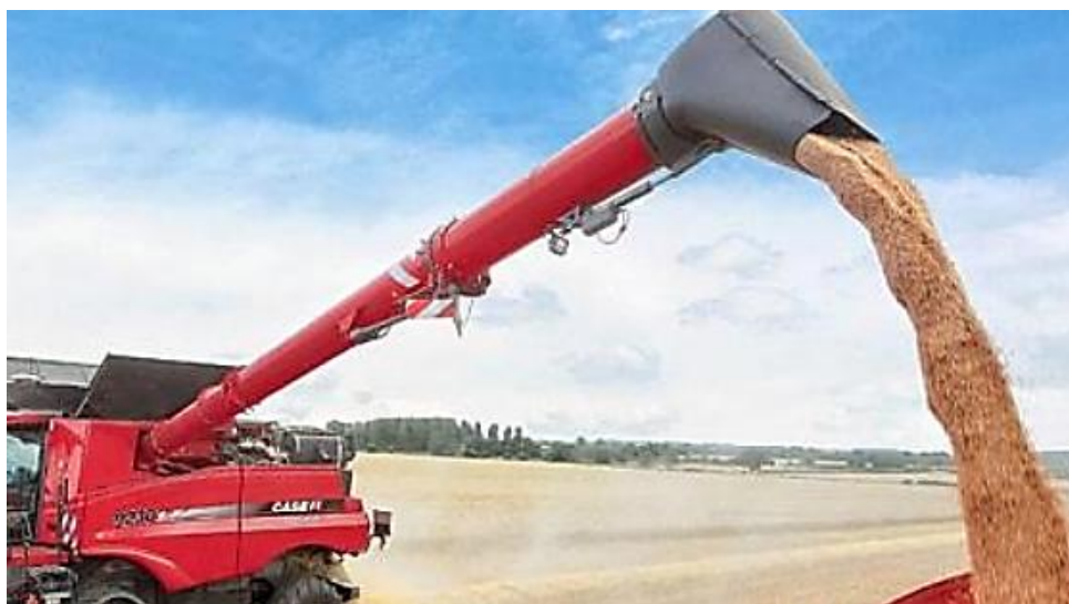
Рисунок 2.5 – Загальний вигляд комбайну з подовженим вивантажувальним шнеком з можливістю його складання
