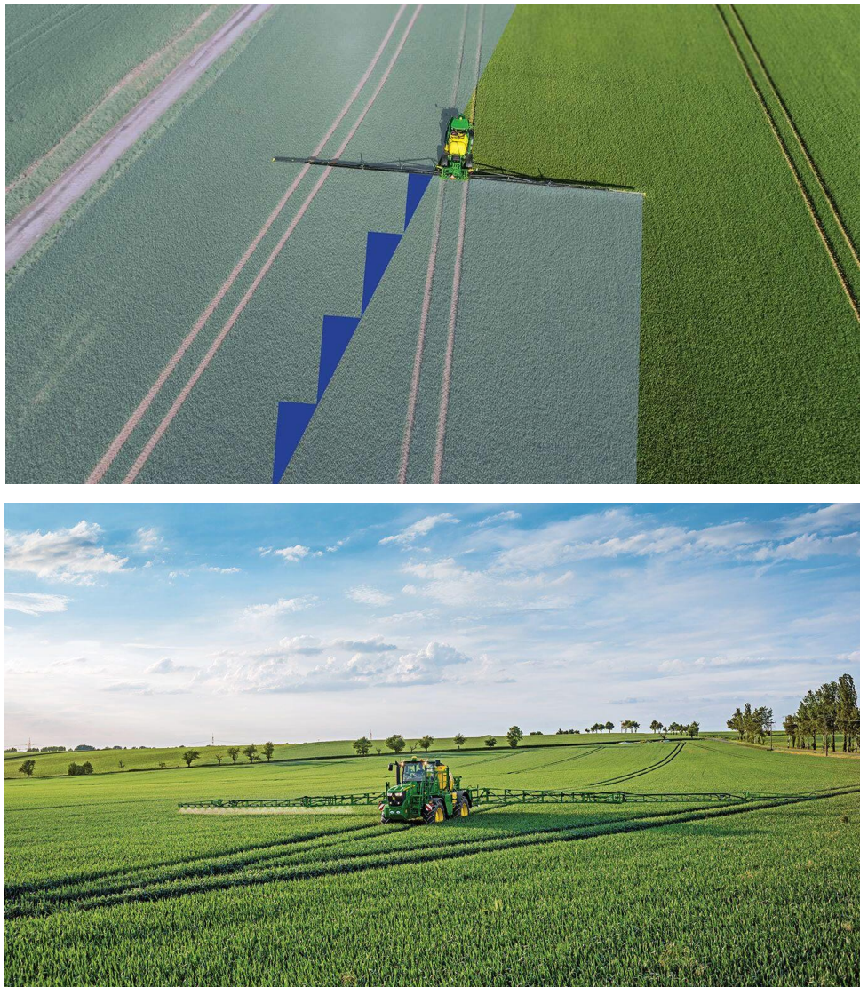
Рисунок 1.4 – Схематичний принцип роботи системи Section Control [13] при перекритті
