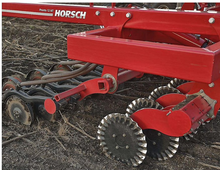
Рисунок 2.3 – Рифлені диски для розрізання ґрунту або пожнивних решток
