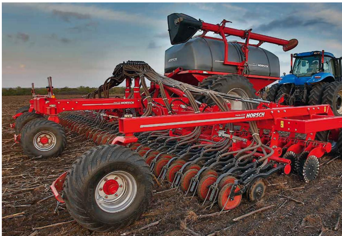
Рисунок 2.2 – Посівний МТА на базі сівалки HORSCH Pronto 12NT
