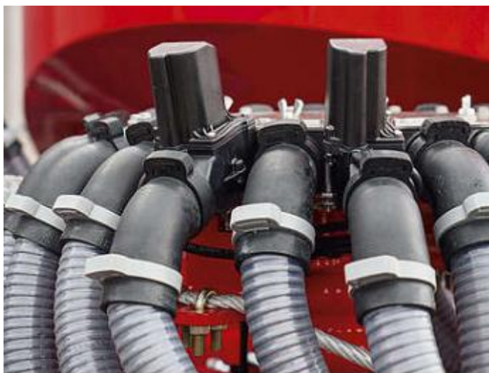
Рисунок 2.4 – Електромагнітні клапани технологічної колії сівалки HORSCH Pronto 12NT
