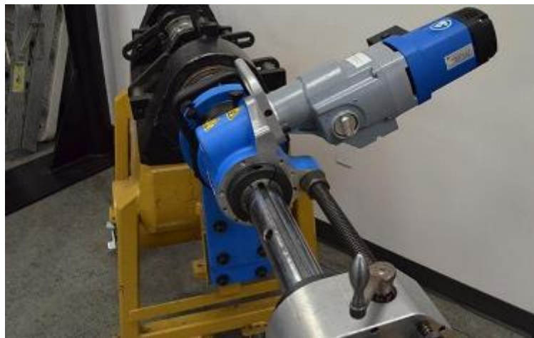
Рисунок 3.2 – Розточувальна лінійна машина CLIMAX BV5000
