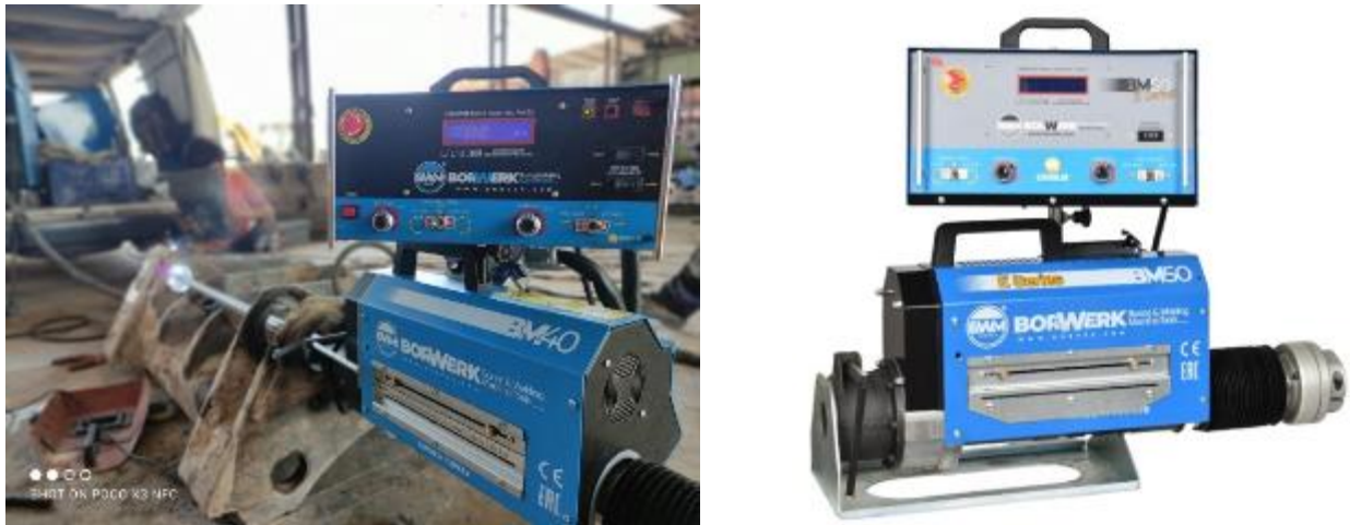
Рисунок 3.3 – Пристосування мобільно розточно-зварювальне типу Borvek BM-40 та BM-50
