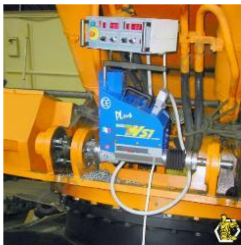
Рис. 3.1 – Пристрій Sir Meccanica серії WS
