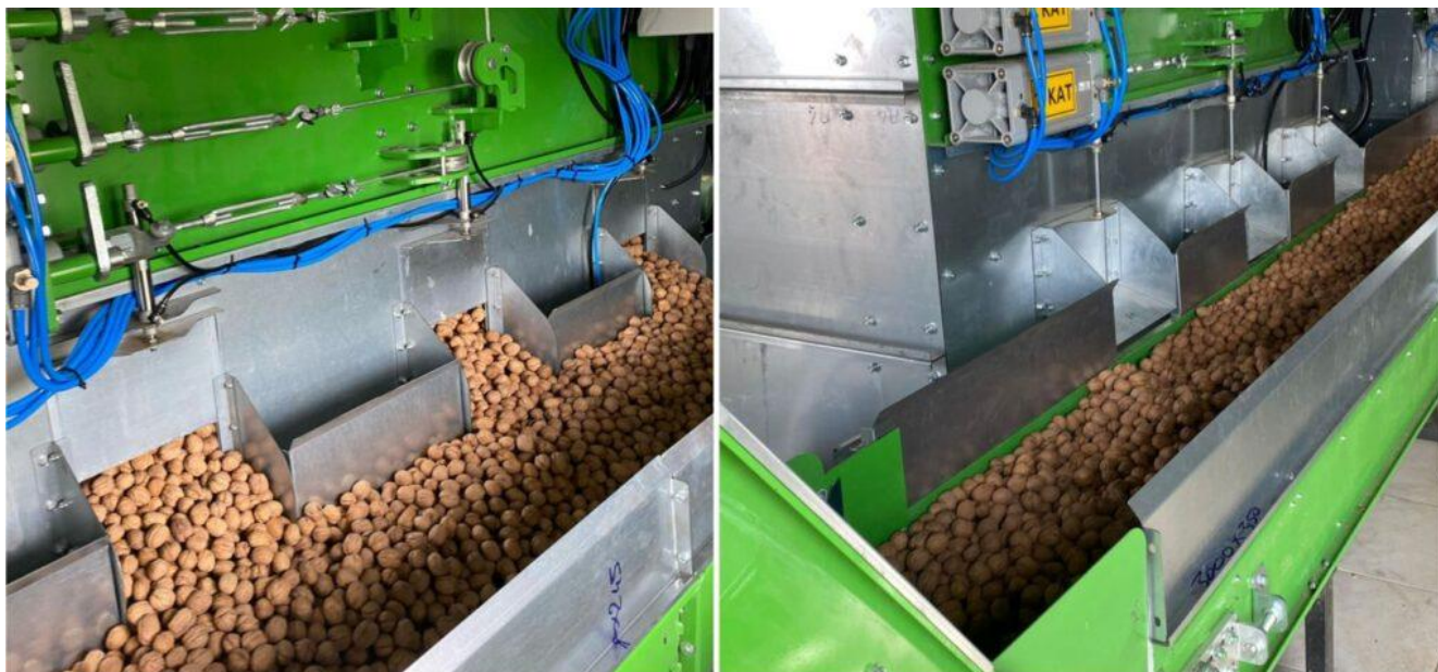
Рисунок 2.2 – Фото технологічної лінії переробки волоських горіхів
