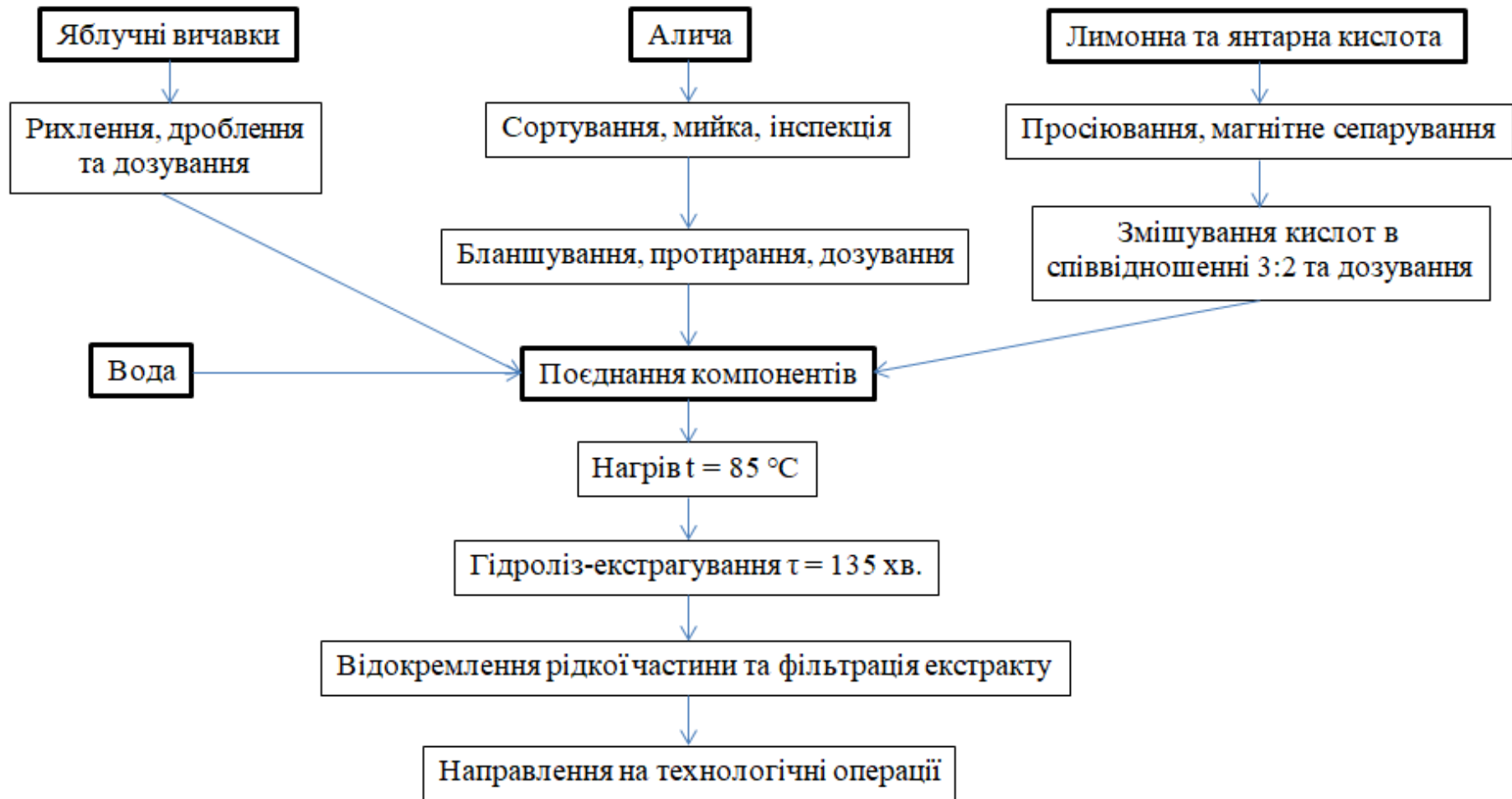
Рисунок 4.1 – Технологічна схема виробництва пектинового екстракту із комбінованої сировини
