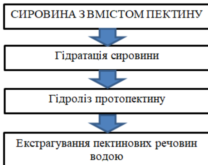
Рисунок 3.6 – Схема принципів процесів, що відбуваються при видаленні пектинових речовин із рослинної сировини
